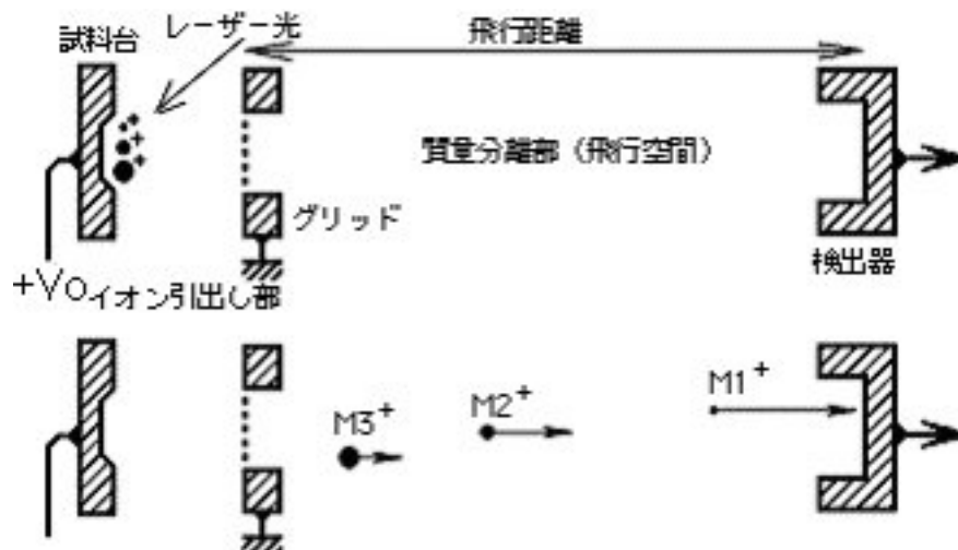
図表 5-5 TOF-MS の原理
